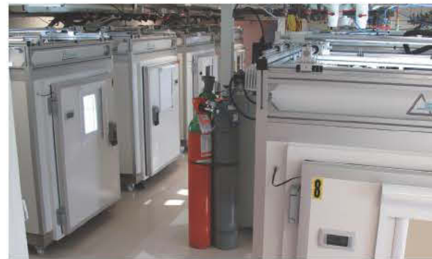
Les chambres de culture de la plateforme Microcosmes. Les bouteilles de gaz sont nécessaires aux marquages et mesures isotopiques. © Jacques Roy
