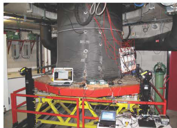
Mesure du quotient respiratoire ( \text{CO}_2/\text{O}_2 ) du sol dans un lysimètre souterrain d'un macrocosme terrestre. La table élévatrice rouge et jaune mesure par pesée l'évapotranspiration de l'écosystème. © Jacques Roy
