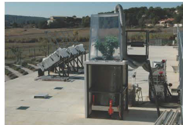
Prototype d'une unité expérimentale de la plateforme Mésocosmes (enceinte canopée au-dessus d'un lysimètre calorifugé ; centrale de traitement d'air à droite). © Jacques Roy
