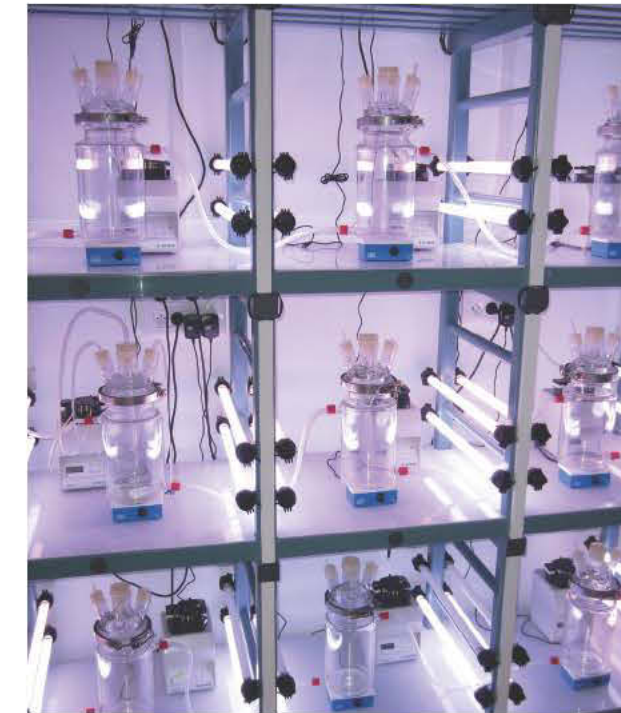
Systèmes de chémostats en laboratoire qui permettent d'élever microalgues et zooplancton simultanément ou séparément en culture continue avec contrôle de la température, de la lumière et de la \text{pCO}_2 . © Sarah Fiorini (CEREEP-Écotron IDF)
