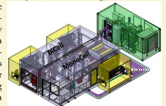
ECOLAB complet composé des modules MonoCell et BiCell couplés à des unités de distribution (jaune) et à une seule unité de production (vert)
