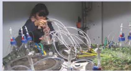
Intérieur d'une enceinte climatique d'Écotab équipée d'un système de 4 mésocosmes terrestres régulés en température dans un lysimètre thermostaté. © Béatriz Decencièrre (CEREEP-Écotron IDF)
