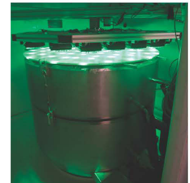
Intérieur d'une enceinte environnementale de l'Écolab équipée d'un lysimètre thermostaté et éclairée par un système matriciel à LED. © CNRS Photothèque / Cyril Fresillon
