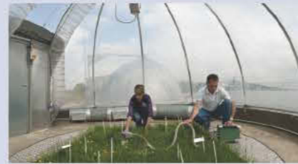
Des chercheurs expérimentent dans un des macrocosmes de l'Écotron européen de Montpellier. Ils mesurent les échanges gazeux entre le sol et l'atmosphère. © CNRS Photothèque / Hubert Raguet
