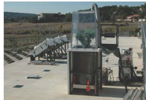
Prototype d'une unité expérimentale de la plateforme Mésocosmes (enceinte canopée au-dessus d'un lysimètre calorifugé ; centrale de traitement d'air à droite). © Jacques Roy
