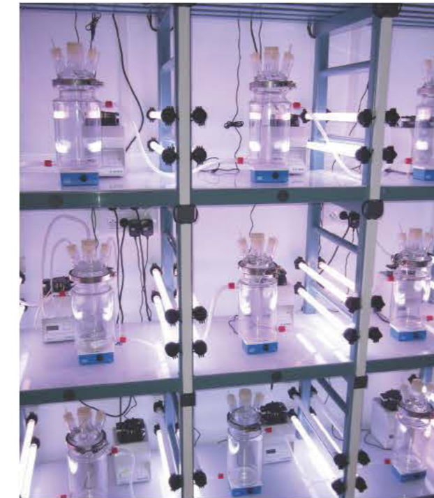
Systèmes de chémostat en laboratoire qui permettent d'élever microalgues et zooplancton simultanément ou séparément en culture continue avec contrôle de la température, de la lumière et de la \text{pCO}_2 . © Sarah Fiorini (CEREEP-Écotron IDF)
